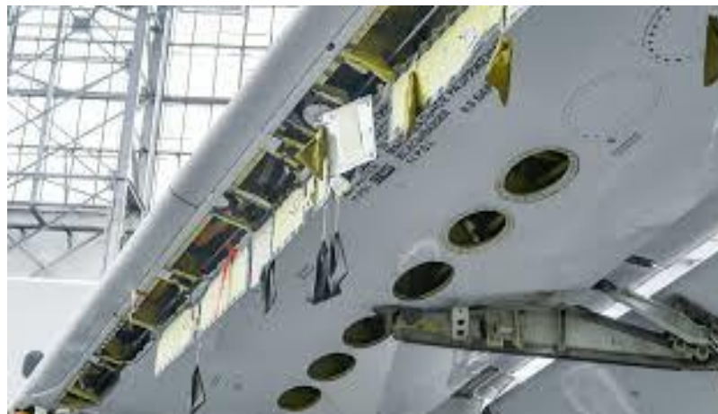
Рисунок 1-Осмотр и контроль топливных баков самолета
